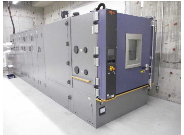
新たに導入した高速温度変化試験装置
